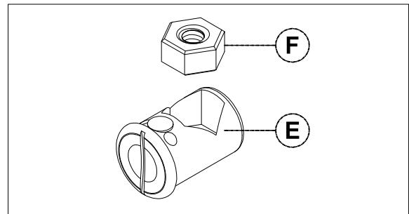
4º - Encaixe as buchas com as porcas nas furações da grade fixa, de modo que no momento da montagem o parafuso passe primeiro pela bucha e depois pela porca, conforme desenhos abaixo:
